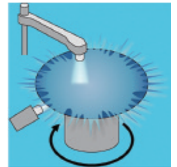
*スピンジェット方式 フラックス洗浄装置で使われる方式。 半導体ウェハーの外周を押さえ、回 転させながら表裏面を同時に洗浄・ 乾燥させる
