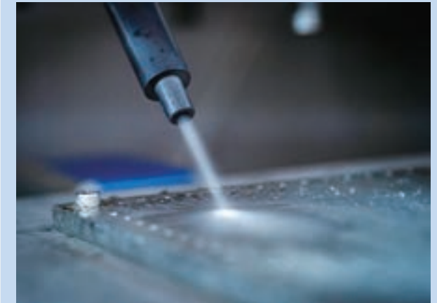
超精密洗浄が可能なマイクロアイスジェットノズル
