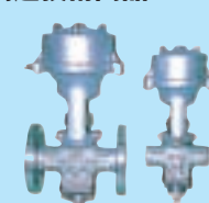
三方ピストン弁 (ロッキーバルブ) 高圧のガス等の流量を調整する弁 主にタイヤメーカーの加硫用に使用
