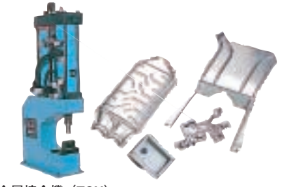
金属接合機 (TOX) 異種金属板を接合する機械 TOXにより接合したもの
