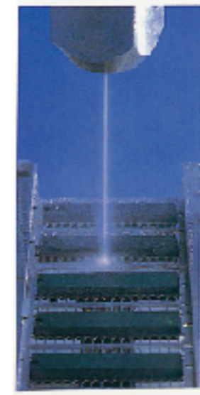
高圧水によるICリードフレームの 樹脂バリ取り作業
